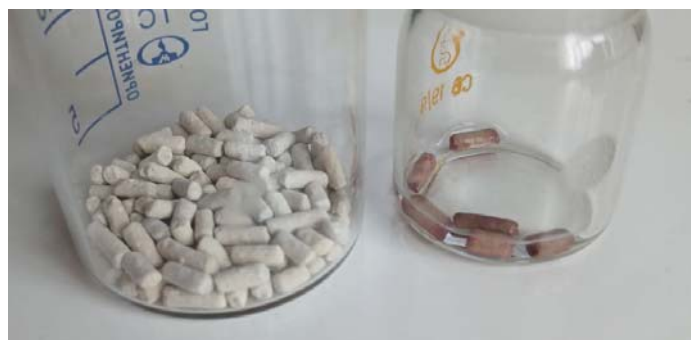
Рисунок 7 – Разница цвета катализатора до и после реакции с щелочью
