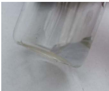
Рисунок 5 – Голубой раствор щелочи после реакции с катализатором
