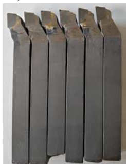
Рисунок 1 – Упорный проходной резец ГОСТ 18879-73
