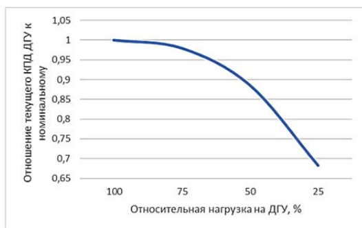
Рисунок 1 – Усреднённая зависимость КПД дизель-генератора от нагрузки
