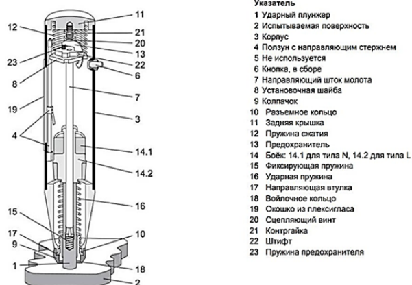
Рисунок 2 – Склерометр для испытаний бетона в продольном разрезе
