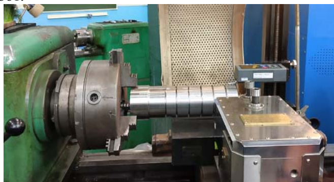
Рисунок 3 – Общий вид станка 1К625 с заготовкой
