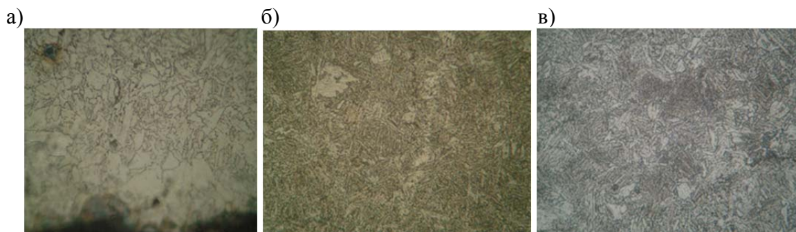
Рисунок 1 - Микроструктура стали 30ХГСА при увеличении 500:
