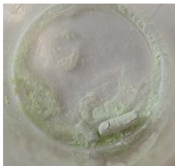
Рисунок 4 – Разрушение катализатора в концентрированной соляной кислоте
