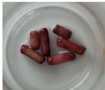
Рисунок 6 - Цвет катализатора после пребывания в щелочи
