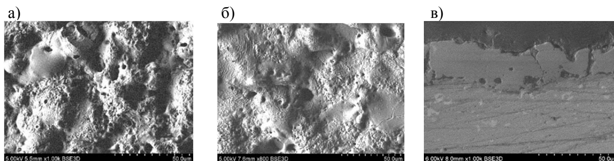
Рисунок 2 - Микроструктура оксидного покрытия:
