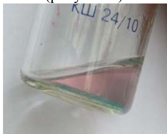
Рисунок 1 – Раствор комплекса (\text{L})_2[\text{CoCl}_4] в этиловом спирте
