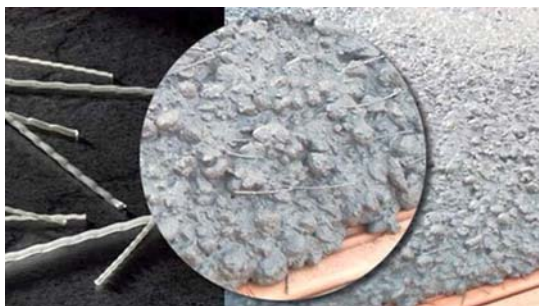
Рисунок 6 - Бетонная масса с равномерно распределенными микроволокнами, препятствующими образованию трещин
