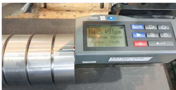
Рисунок 4 – Портативный измеритель шероховатости TR200
