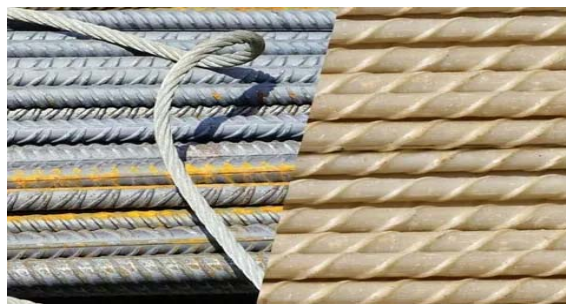
Рисунок 7 - Металлическая арматура и неметаллическая
