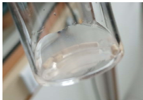
Рисунок 3 – Разрушение катализатора в серной кислоте
