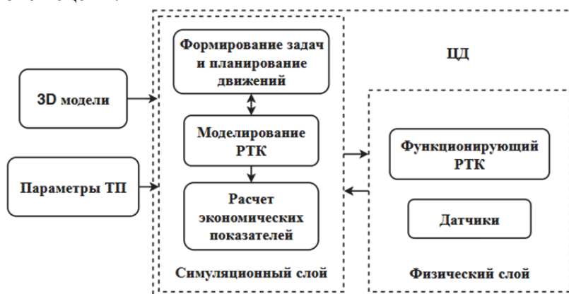
Рисунок 1 – Структурная схема ЦД РТК
